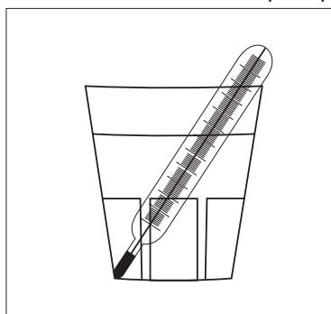
температуру продуктов, хранящихся в холодильнике, установите ручку терморегулятора в среднее положение, поставьте стакан с водой в центр камеры и опустите в него термометр с точностью градуировки  $+/- 1^{\circ}\text{C}$ . Если через 6 часов показание термометра соответствует показанию дисплея, холодильник работает нормально. Измерения необходимо проводить в стационарном режиме работы (без изменения нагрузки).
